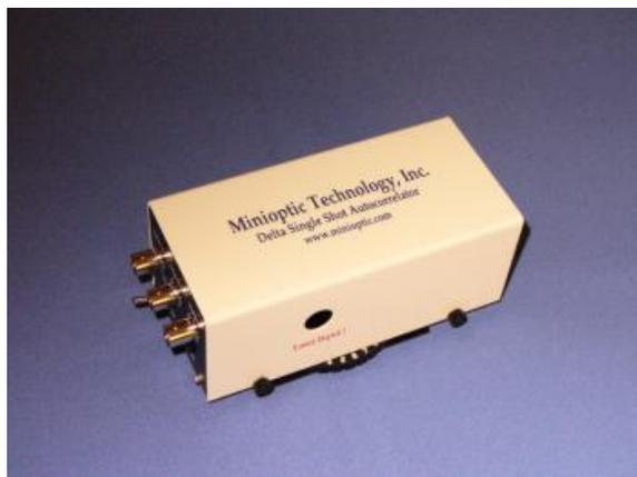
Delta 单发自相关仪是检测和测量超快激光脉冲宽度的最理想的工具，能够测量 10fs 到 100ps 的脉冲宽度，1Hz 到 1GHz 的重复频率，覆盖 500nm 到 2000nm 的波段范围，光路易调，测量简便，最小的体积可达  $15 \times 7 \times 6.8 \text{ cm}^3$ ，并采用三角形干涉仪(延迟线)的设计，具有比其他自相关仪更优的性能和更低的价格。
